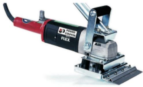
Das Wellenschliffmesser wurde speziell zum Entfernen von Belägen mit Filz-/Vliesrücken entwickelt.
