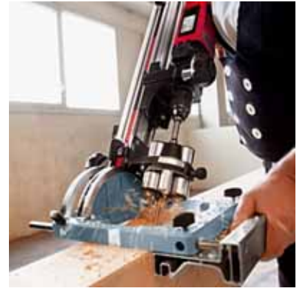
Die HB E im Einsatz mit der MAFELL-Bohrstation.
