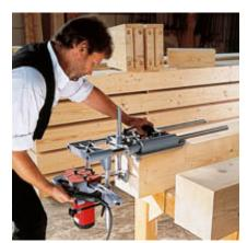
Hochpräzise Fräsungen für hochwertige Knotenblechverbindungen im Ingenieurholzbau.
