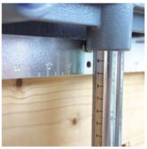
Der vertikale Randabstand kann über eine Skala exakt eingestellt werden.
