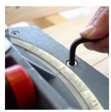
Das Schlitzgerät kann beidseitig bis 45° geschwenkt werden.
