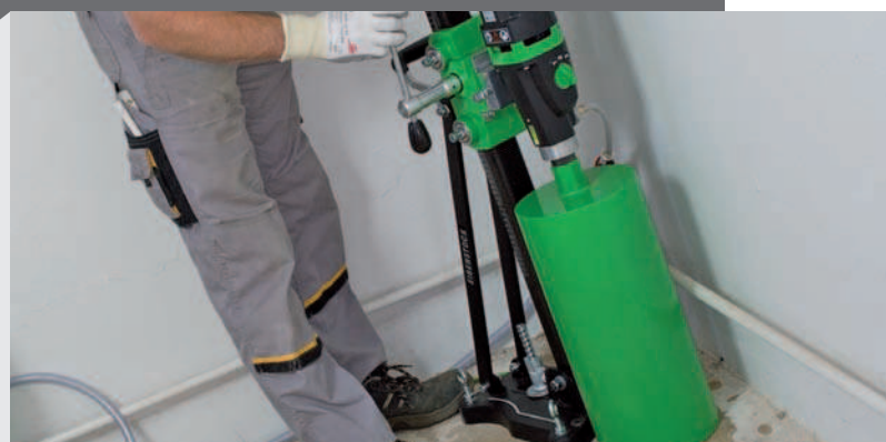
BST 182 V/S: auf vier Spezialkugeln gelagerter Schlitten
