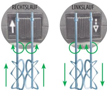
Rührquirle arbeiten sich in das Material ein und befördern es nach oben, geringe Luft einschließen, leichtes Führen
